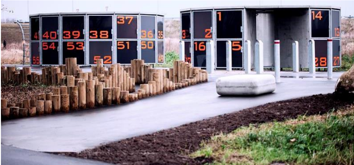
Figur 7.7 Parkeringsanlæg ca. 7 km fra Aarhus centrum med bilparkering og den her viste cykelparkering. Denne sker i aflåste bokse, hvor der også er plads til taske o.lign. Foto: Vejdirektoratet.
