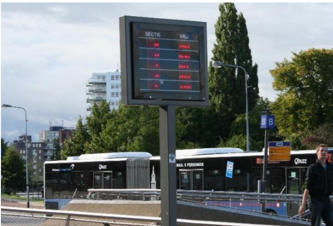
Figur 7.4 Eksempel på anvisning af ledig cykelparkeringsplads i større anlæg – Groningen Station, Holland. Foto: COWI.
