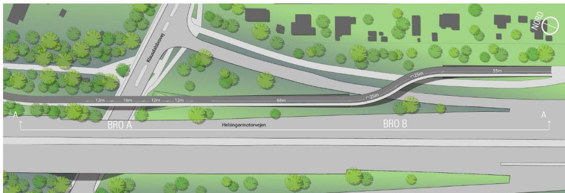
Figur 4.22 Illustration af mulig udformning af stibroer ved Klausdalsbrovej på Farumruten til at erstatte stikrydsning i niveau på større trafikvej. Kilde: Idealløsninger til forbedring af fremkommeligheden, Supercykelstisekretariatet, 2014.
