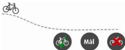
Figur 7.1 Korrekt placering af cykelparkering. Kilde: "Anlæg for parkering og standsning i byer".
