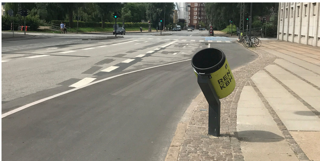
Figur 9.5: Eksempel på cykelvenlig skraldespand på Albertslundstrøen i Københavns Kommune. Skraldespanden er placeret på en stander, som vinkler skraldespanden ud mod cykelstien. Ved placering af cykelvenlige skraldespande skal man være opmærksom på, at de ikke begrænser fremkommeligheden for fodgængere.
