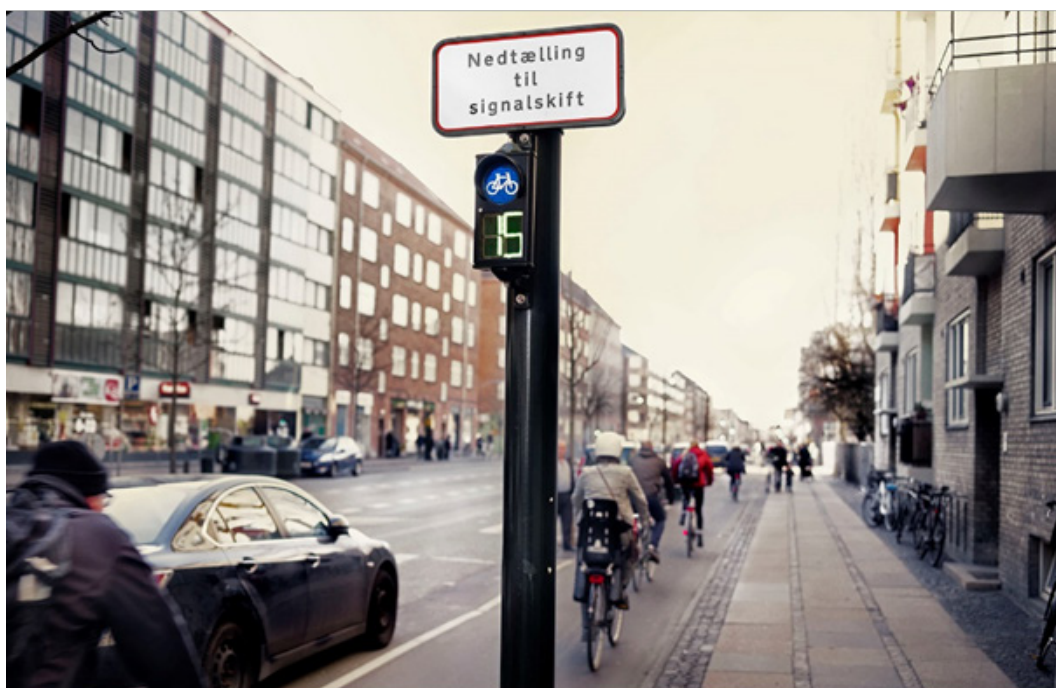
Figur 5.5: Eksempel på nedtællingssignal til signalskift i nærliggende signalanlæg. Nedtællingssignalet er placeret langs cykelstien mellem signalkryds. Eksempel er fra Albertslundruten, Frederiksberg Kommune.
