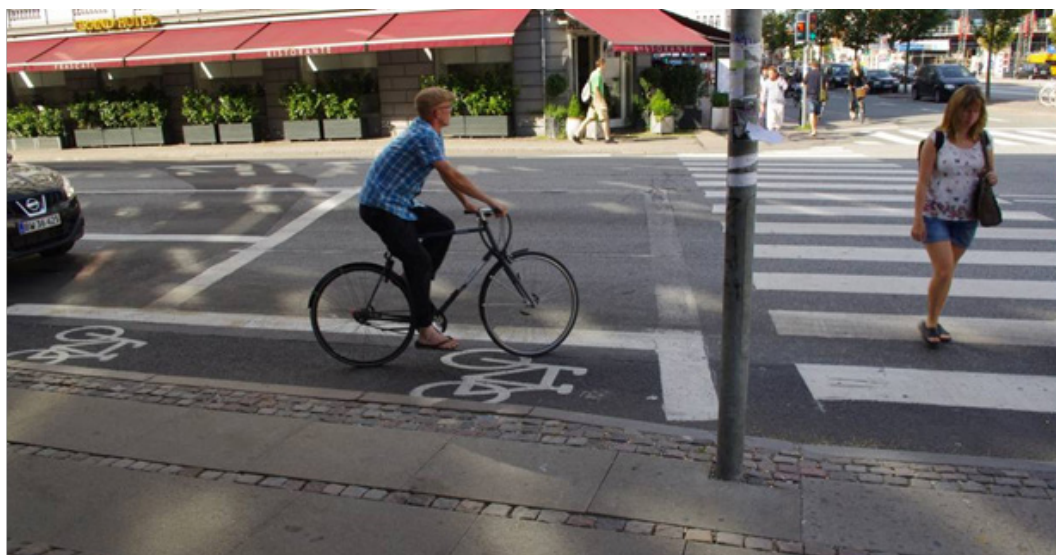
Figur 5.8: Eksempel på smal cykelbane ført frem til kryds (Københavns Kommune).
