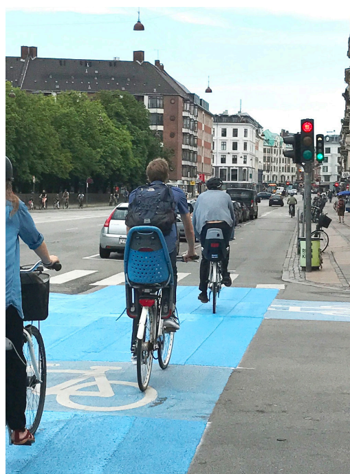
Figur 5.4: Eksempel på separat cyklistsignal med førgrønt for cyklister på Københavnerruten i Københavns Kommune.
