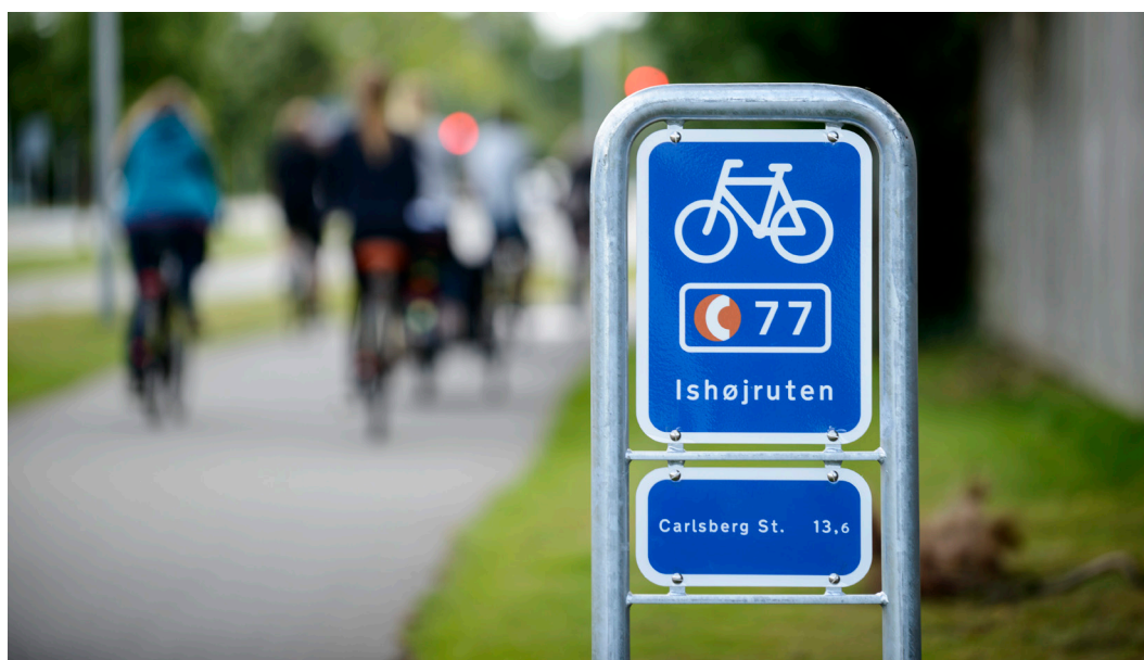
Figur 8.1: Illustration af brug af L46 tavle med ruteindikation for Supercykelsti. Tavlen er opsat på Ishøjruten.
