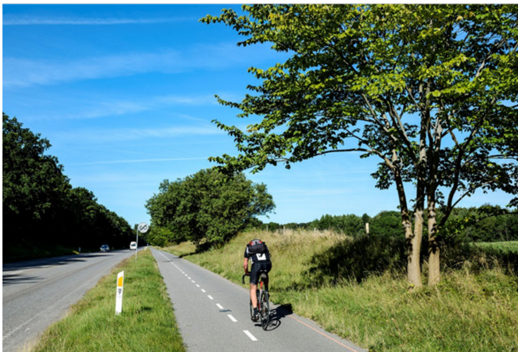
Figur 4.13: Eksempel på dobbeltrettet sti langs vej i åbent land med en adskillelse på min. 1,5 m til kørebanelen (Farumruten, Furesø Kommune).
