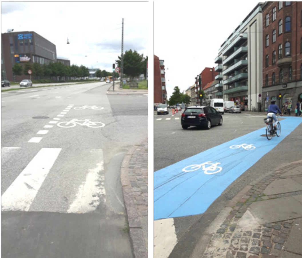
Figur 5.9: Brug af cykelfelter afgrænset af bred punkteret linje eller blå farve kan anvendes i kryds, hvor der vurderes at være særlige behov for opmærksomhed fra svingende biltrafik (Indre Ringrute).
