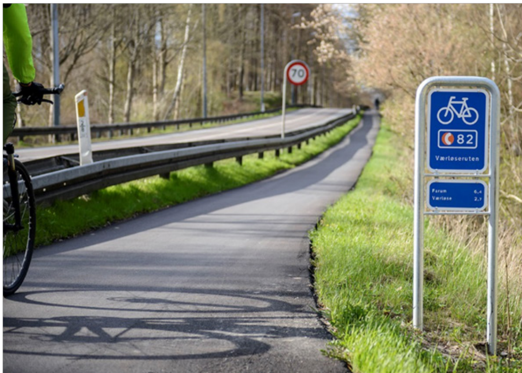
Figur 8.2: Eksempel på brug af L46 tavle på Værløseruten med ruteidentifikation og vejvisningsmål ved byer langs ruten.
