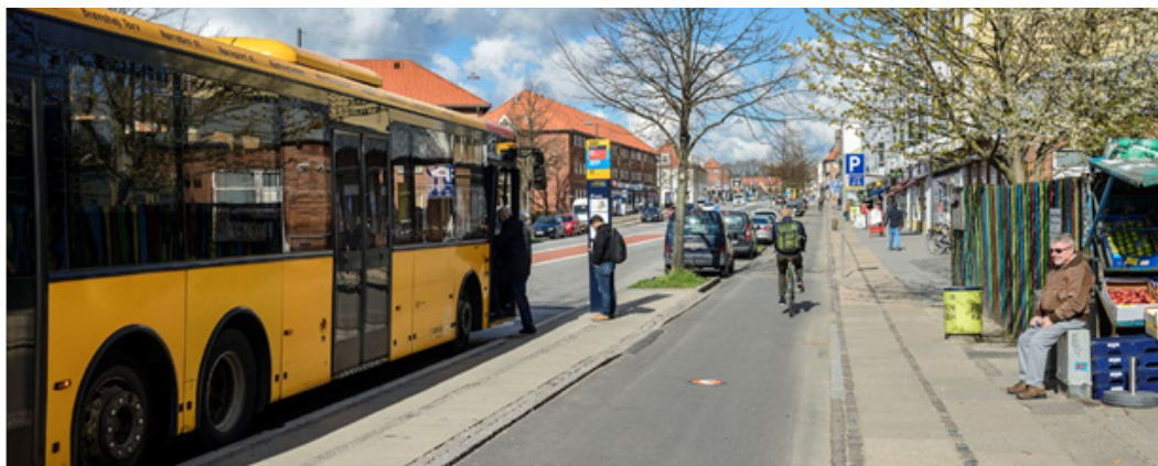
Figur 5.12: Eksempel på busstoppested med perron, så vigepligten er tydeliggjort for buspassagererne. Eksemplet er fra Frederikssundruten, Københavns Kommune.
