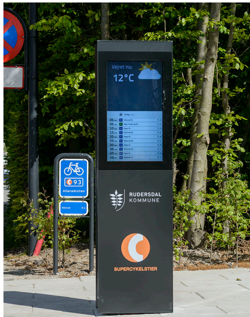
Figur 9.4: Eksempel på cykelbarometer på Allerødstrøen i Rudersdal Kommune, hvor bl.a. information om antal cykler og vejret kan vises.
